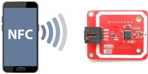
Fig. 1. Modul NFC PN532 (NFC Reader)
