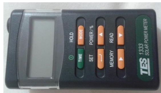
Fig. 3. Digital solar power meter
